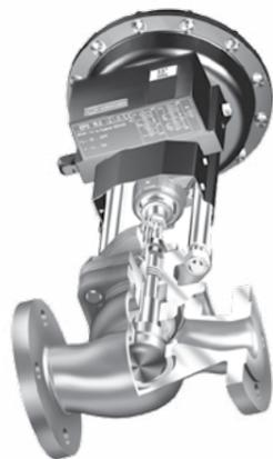
Запорный проходной клапан с фланцами, с электрическими или пневматическими приводами, DN 15—500, PN 16 — PN 40, материал: EN-JL1040, EN-JS1049, 1.0619+N, 1.4408.
